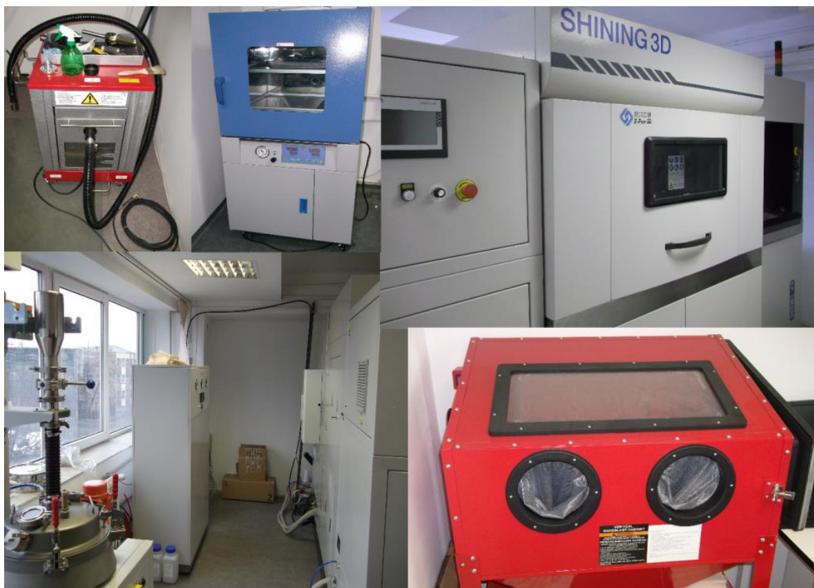
Camera echipamentului de prototipare prin sinterizare metale cu laser si componentele tehnologice ale acestuia
